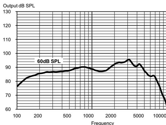
**Datos técnicos** Datos típicos obtenidos durante un procedimiento de medición estándar con tonos puros. Audífono en Modo de test 1 de Compass, de no ser así, se indicará. Medidos con un acoplador ITE estándar.
